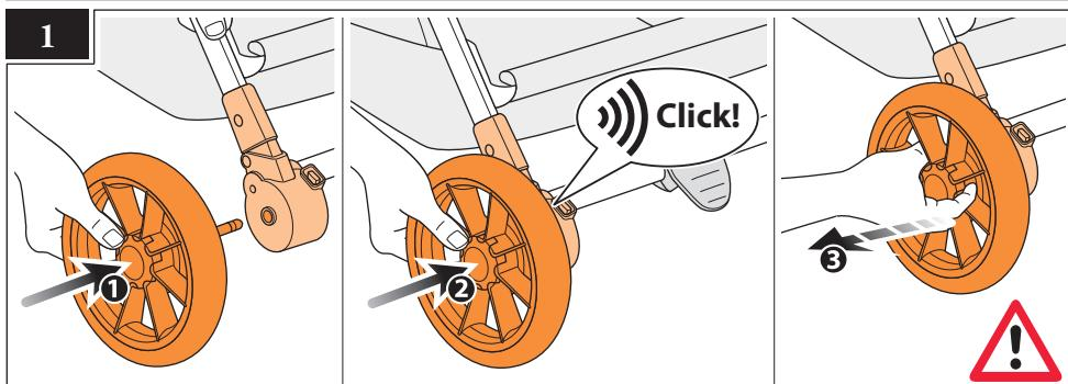
IT RUOTE ANTERIORI • EN FRONT WHEELS • FR ROUES AVANT • DE VORDEREN RADAGGREGATE • ES RUEDAS
